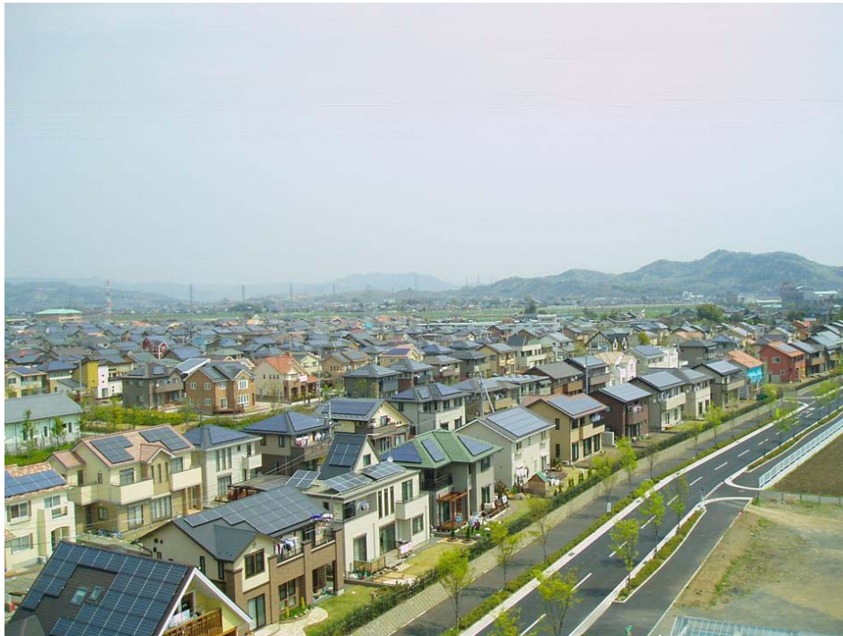
Figure 14 - Exemple de forte densité sur un même départ BT, localité d'Ota City au Japon (source NEDO)
